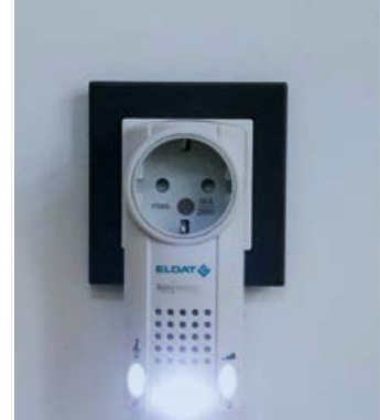
Lichtblitzklingel, an die ein Signal gesendet werden kann
