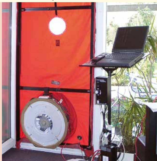
Ventilator zur Durchführung eines Drucktests
